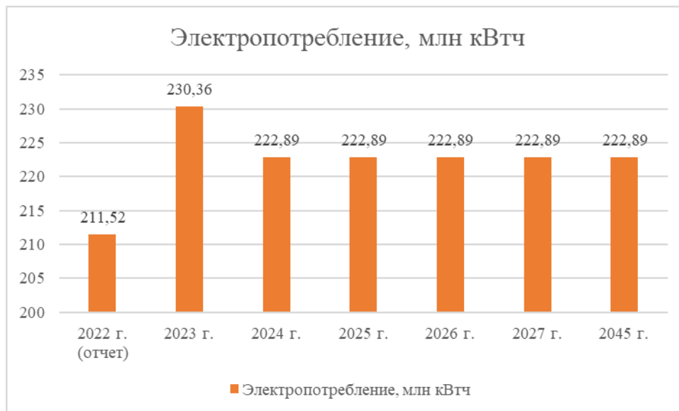
Рисунок 8.1 – Динамика потребления электрической энергии изолированных энергоузлов Камчатского края за отчетный 2022 г. и на перспективу 2023–2045 гг.
