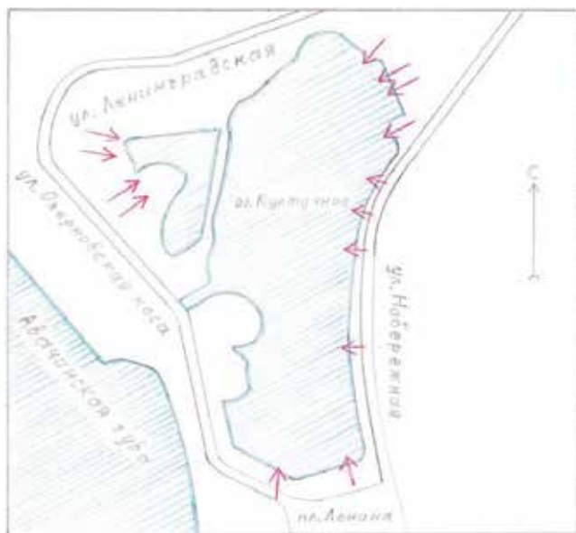
Рис. 2. Схема расположения выпусков дождевой канализации (указаны стрелками) в озеро Култучное (схема авторов).
