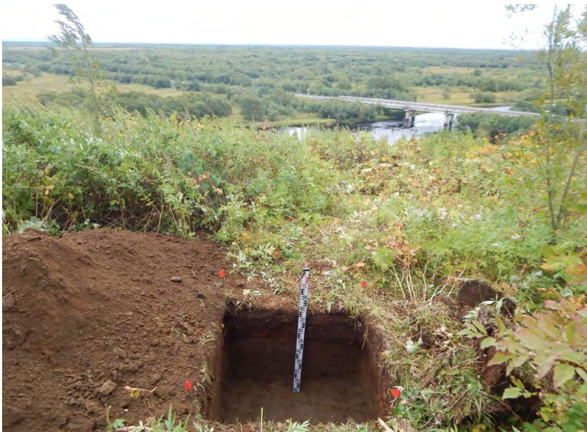
Рис. 42. Шурф № 4. Характер рыхлых отложений. Восточная стенка.
