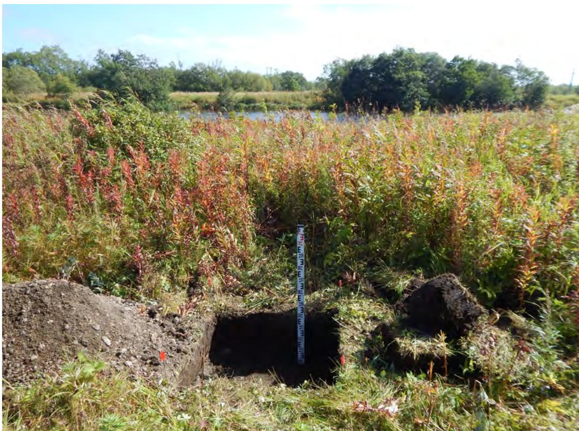
Рис. 104. Шурф № 14. Характер рыхлых отложений. Стратиграфия. Восточная стенка.
