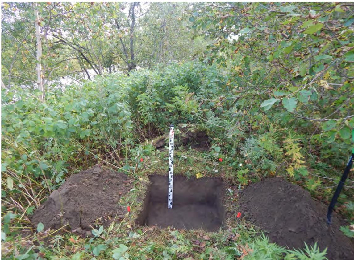
Рис. 140. Шурф № 21. Характер рыхлых отложений. Восточная стенка.
