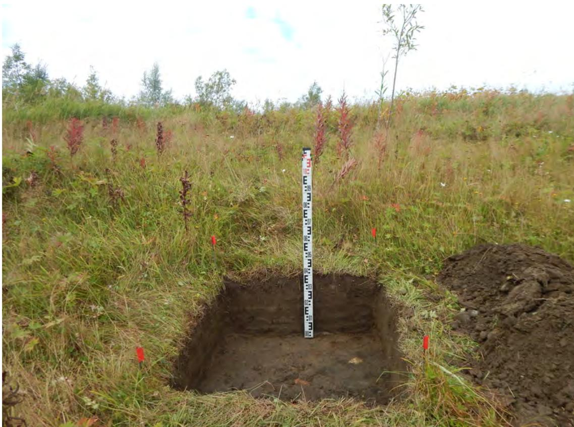
Рис. 134. Шурф № 20. Характер рыхлых отложений. Стратиграфия. Восточная стенка.
