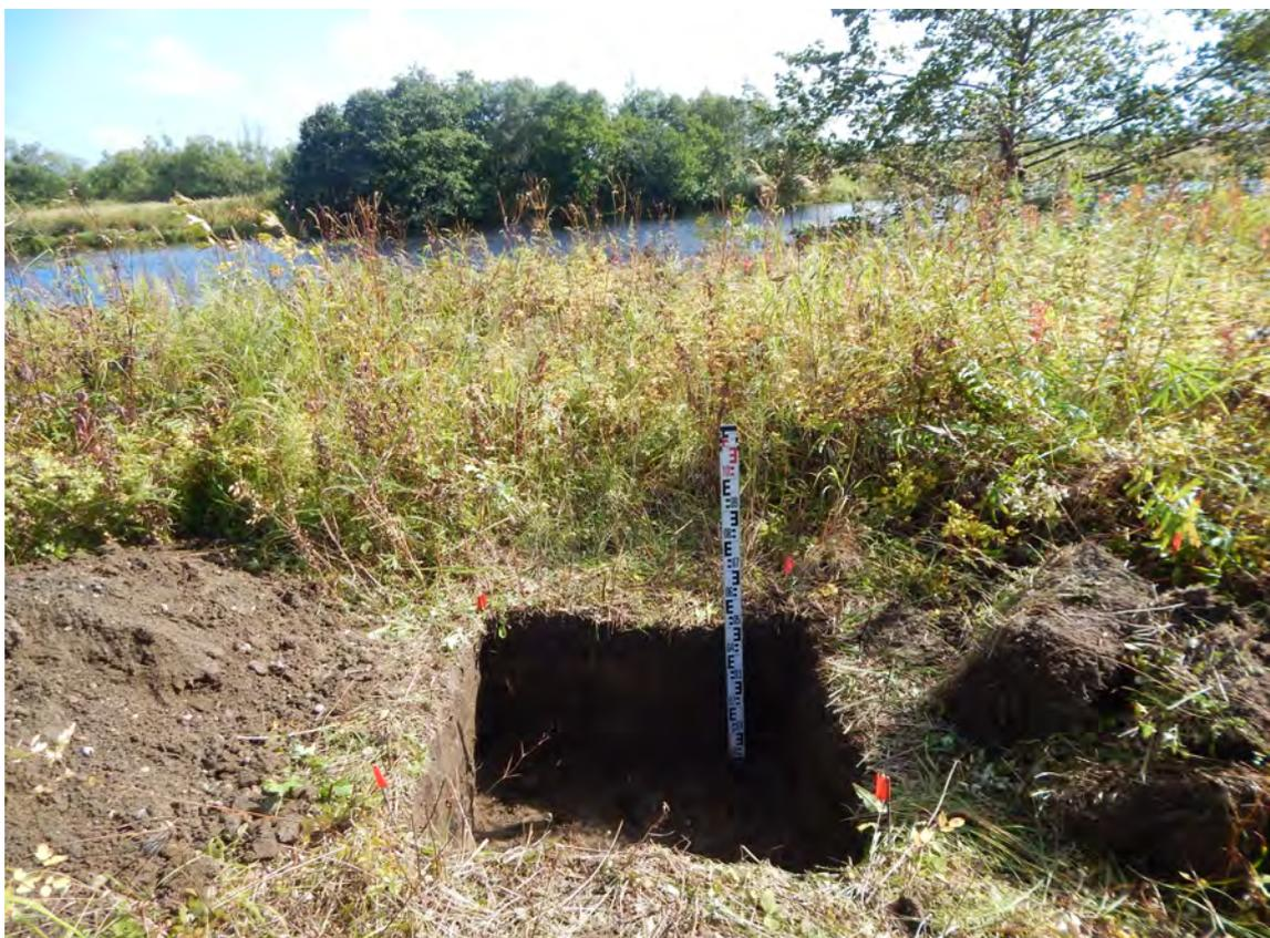
Рис. 100. Шурф № 13. Характер рыхлых отложений. Стратиграфия. Восточная стенка.
