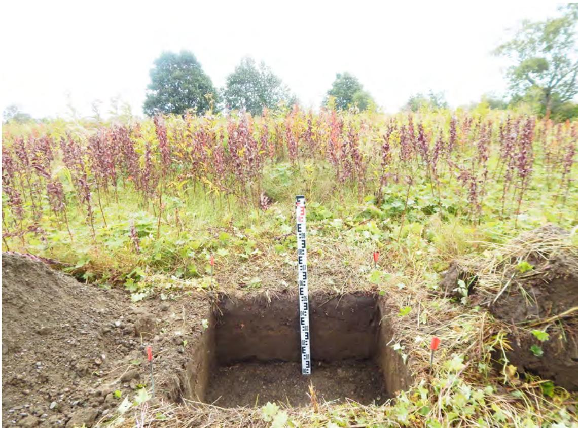
Рис. 128. Шурф № 19. Характер рыхлых отложений. Стратиграфия. Южная стенка.
